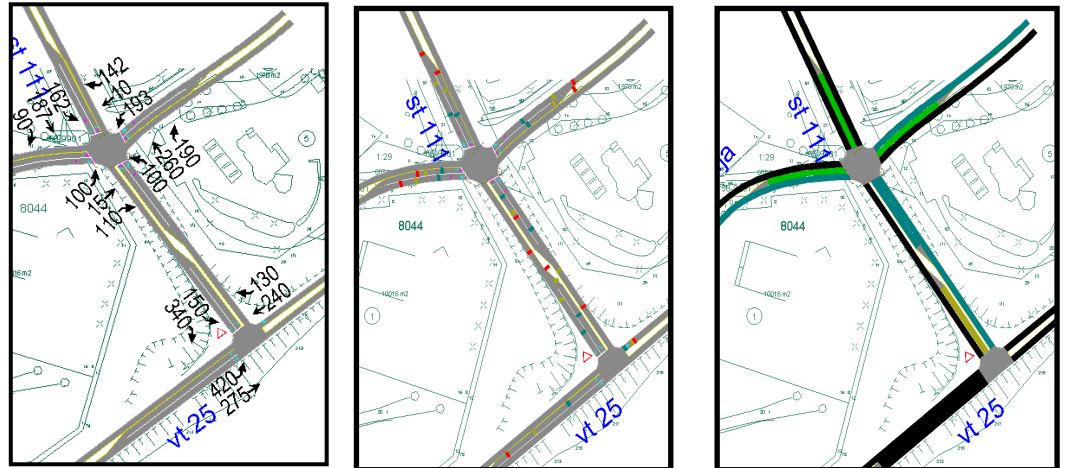
Kuva 7 Tarkastelutilanteessa 2030 toimivuus Uikkukujan maankäytön toteutuessa tilaa vaativana erikoistavarakauppana. Esityksessä Uikkukujan liittymässä on toteutettu valo-ohjaus. Uusia kaistajärjestelyitä on toteutettu molemmissa liittymissä.
